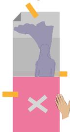
Séparer le papier transfert du liner sur la partie basse du stickers jusqu'au ruban adhésif nouvellement remplacé. Placer un ruban en haut du papier transfert pour le tenir vers le haut de la surface.
